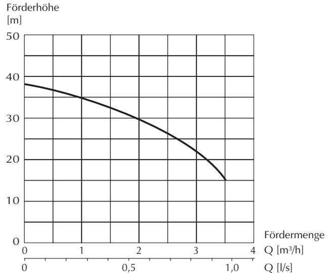
Bild 5 Pumpenkennlinie: Fördermenge in Abhängigkeit von der Förderhöhe
